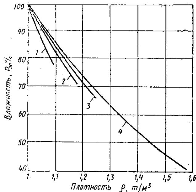
Рис. 5. Значения плотности в зависимости от влажности осадка станций осветления и обесцвечивания воды
