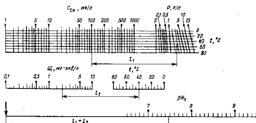
Рис. 1. Номограмма для определения рН насыщения воды карбонатом кальция (рН<sub>s</sub>)
